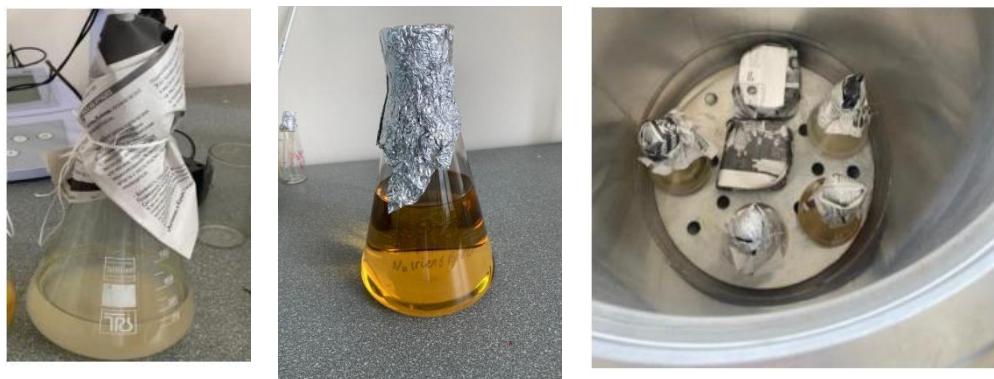
Рисунок 6 – Приготовление питательных сред из Nutrient Agar / Nutrient Broth и помещение в автоклав
